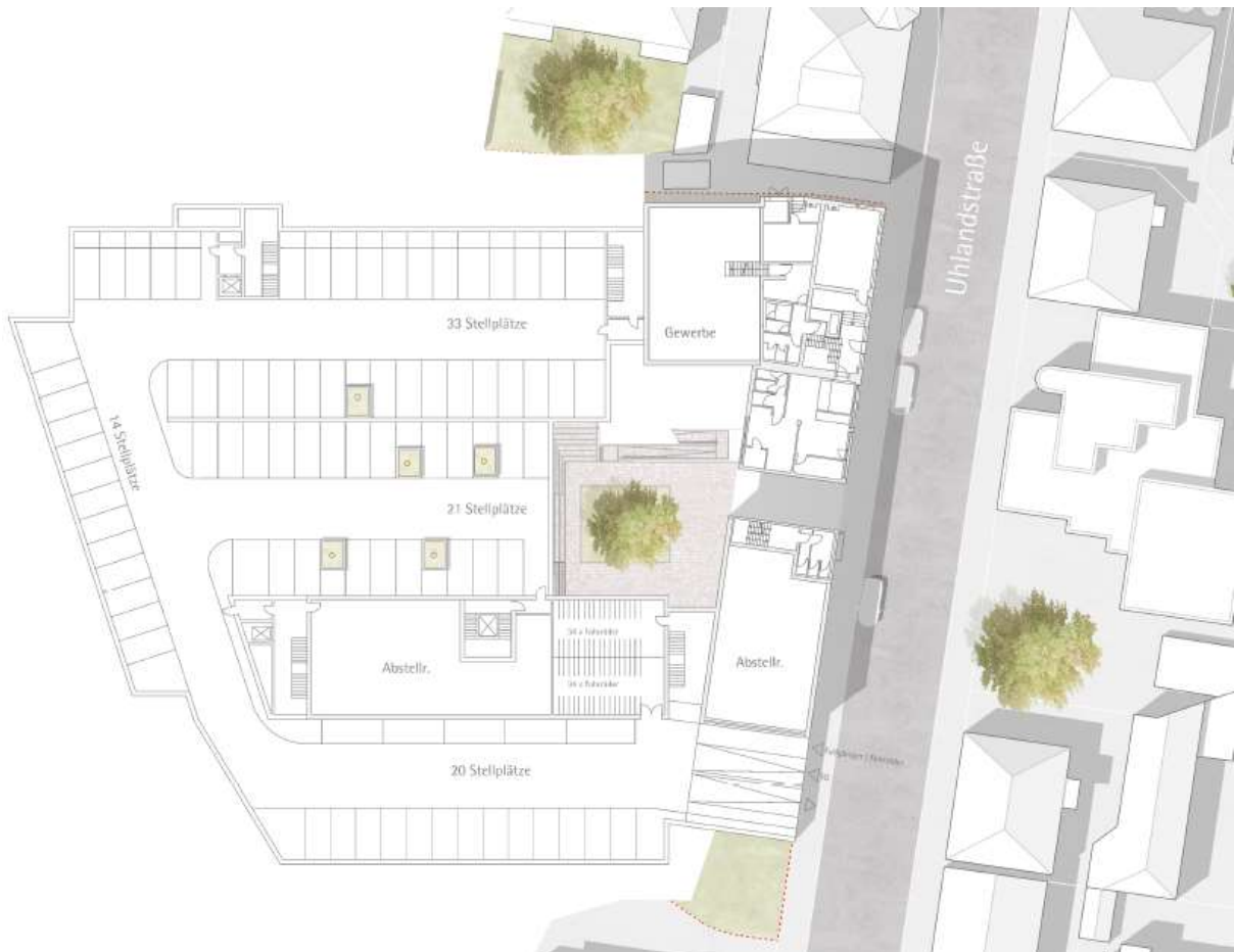
Grundriss UG / Tiefgarage mit 88 Stellplätzen
