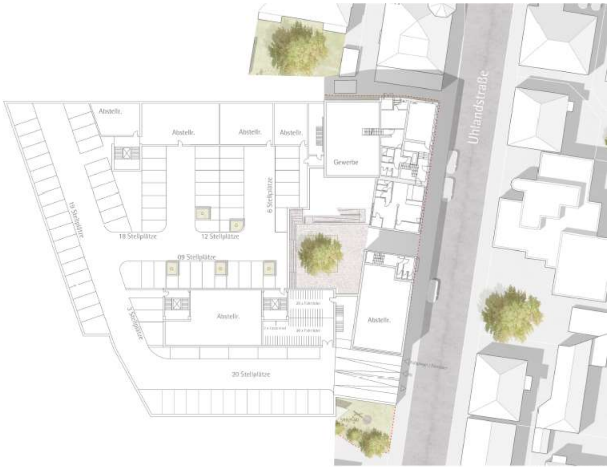
Grundriss UG / Tiefgarage mit 87 Stellplätzen
