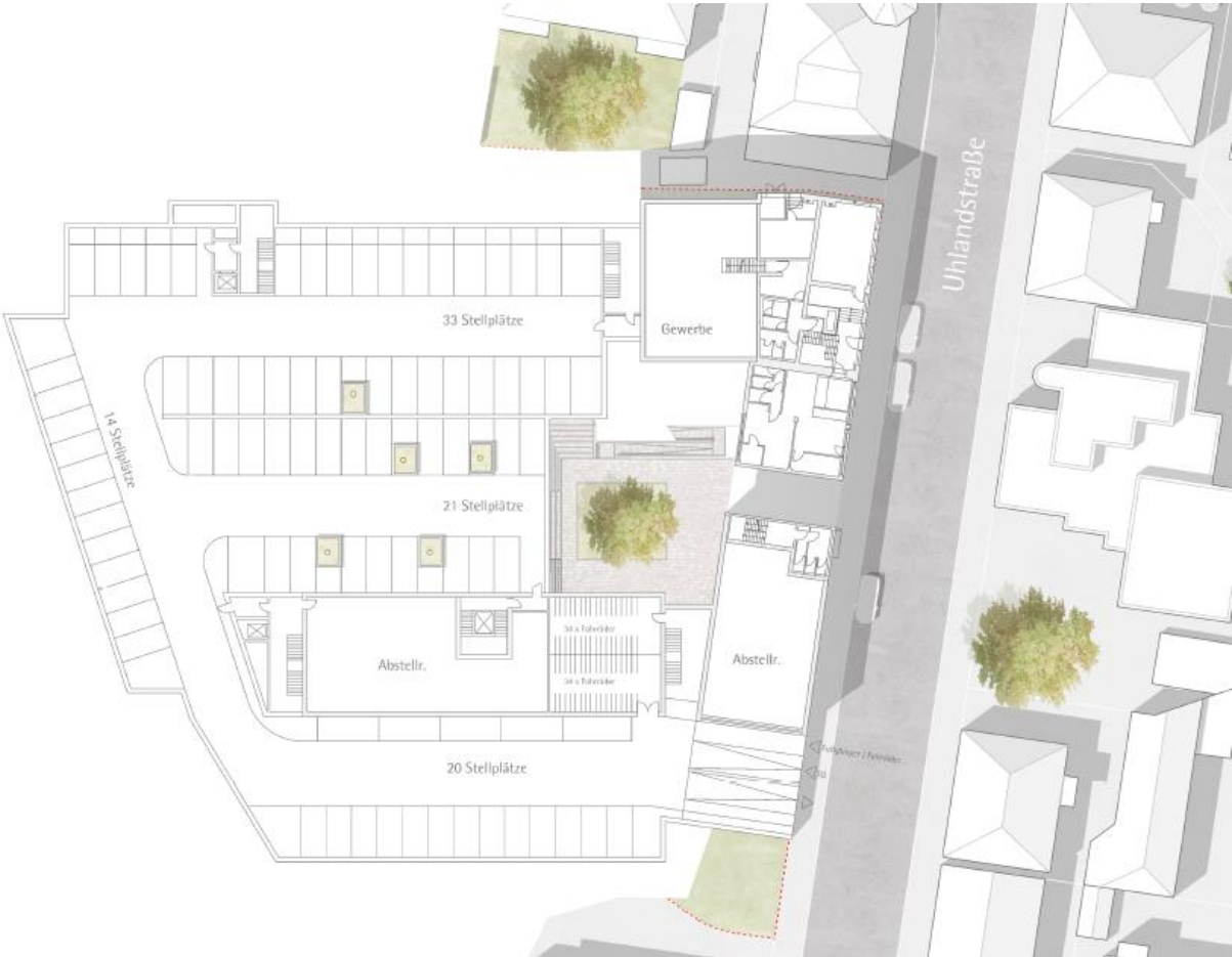
Grundriss UG / Tiefgarage mit 88 Stellplätzen
