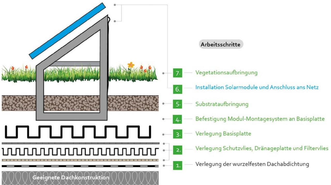
Abbildung 1: Dachaufbau eines Solar-Gründachs (Quelle: Bundesverband GebäudeGrün).
